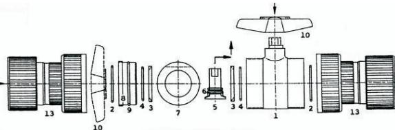
Recomendamos lubricar la esfera y el vástago con grasa de silicona. Las roscas deben ajustarse manualmente. Las piezas sueltas están dibujadas en el orden en que se deben armar sobre el cuerpo 1). El sentido lo indican las flechas. El vástago 5) junto con los dos O'Ring 6) se introducirán en el cuerpo 1) hasta el centro, luego se empujará hacia afuera para que sobresalga, y hasta que haga tope.
